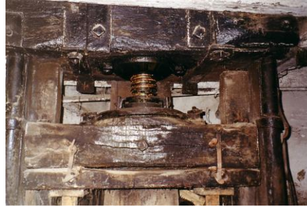
Détail du pressoir : vis axiale, écrou et traverse mobile.
